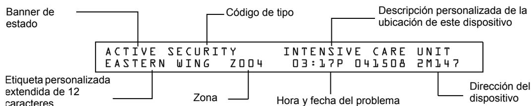
**Figura 3.7 Ejemplo de mensaje de alarma de seguridad**
