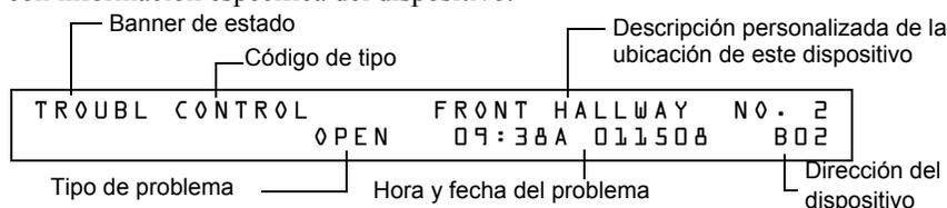
**Figura 3.1 Ejemplo de mensaje de NAC en condición de problema**
